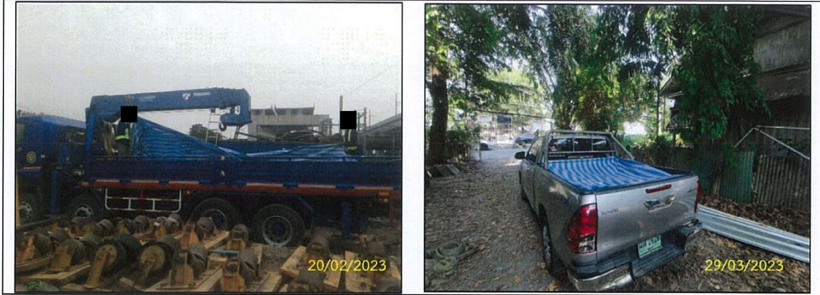
รูปที่ 2-6 การปิดคลุมวัสดุอุปกรณ์ก่อสร้างขณะขนส่ง
